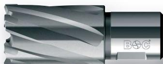
Fraises à carotter avec arêtes de coupe en carbure. Convient pour acier (poutres en T, tôle grand format), acier inoxydable comme AISI 304 et AISI 316, métaux non ferreux et légers.
